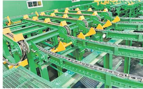
включал в себя установку новых моторов-редукторов повышенной мощности, а также внедрение новой системы датчиков, которые позволяют специалистам контролировать движение сырья и более точно регулировать межторцевое расстояние между бревнами. Оборудование успешно прошло все тестовые испытания и доказало свою надежность.
