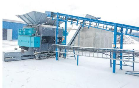
В Устьянском ЛПК успешно завершены испытания отечественных режущих ножей на рубительной машине Vecoplan. Разработку российских инженеров установили взамен оригинальных импортных запчастей. Несколько недель их тестировали в работе при максимальной загрузке отходами лесопиления — все ножи прошли тестовые испытания. В настоящее время решается вопрос о полном переводе рубительных машин ЛПК на отечественные режущие инструменты.
